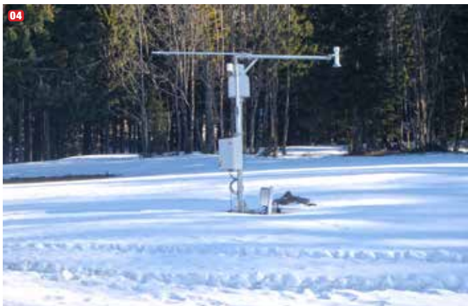
03 Bei noch üppiger Schneelage wurde am 28.11.2013 die neue Station Wastl am Wald aufgebaut. (Foto: LWD Niederösterreich) | 04 Die Schneehöhenmessung war zwar bereit für die Schneefälle, diese blieben jedoch weitgehend aus, weshalb die Messstation nicht wirklich gefordert war (aufgenommen am 04.02.2014). (Foto: LWD Niederösterreich) | 05 Temperatur- und Niederschlagsverhältnisse in Niederösterreich (November 2013 bis März 2014). (Quelle: LWD Niederösterreich) |
