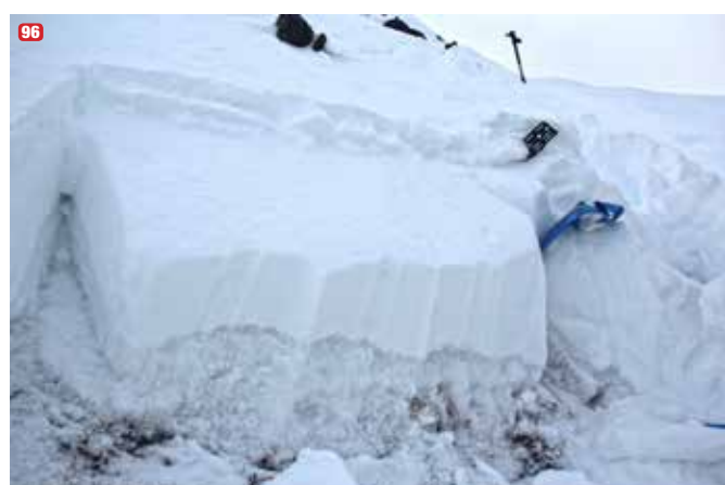
96 Schneeprofil oberhalb des Anrisses: Man erkennt deutlich den massiven Schwimmschneestock (nicht so deutlich zu erkennen sind ältere, im Abbau befindliche Regenkrusten innerhalb der Schwimmschneeschicht). (Foto: LWD Tirol) |
