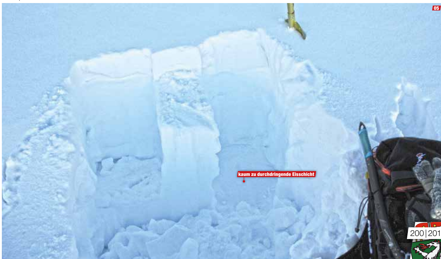
05 Schneeprofil im Dachsteingebiet Mitte Februar in 2300 m Seehöhe: Die zugeschnete Eisschicht ließ sich mit der Lawinenschaufel nur schwer durchstoßen. (Foto: Axl Possesser) |
