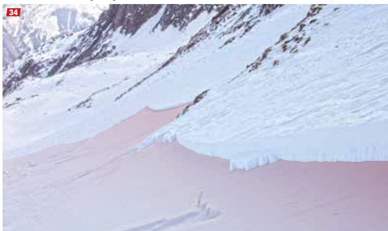
34 Das Unfallschneebrett bricht in mehreren Schichten im unteren Drittel der Altschneedecke. Das Bild zeigt die primäre Bruchfläche des trockenen Schneebretts, die in diesem Bereich rund 30 bis 40 cm über dem Grund liegt. (Foto: LWD Salzburg) | 35 Das Unfallschneebrett liegt in einer leichten Vertiefung (schwach ausgeprägten Rinne) und bricht in mehreren Schichten im Mittelteil bzw. im unteren Drittel der Altschneedecke. Rechts im Bild erkennt man einen 2 cm-Spalt, der mit dem Finger herausgekratzt wurde – dabei handelte es sich um griesigen Schwimmschnee, der wie Zucker herausrieselt. (Foto: LWD Salzburg) |
