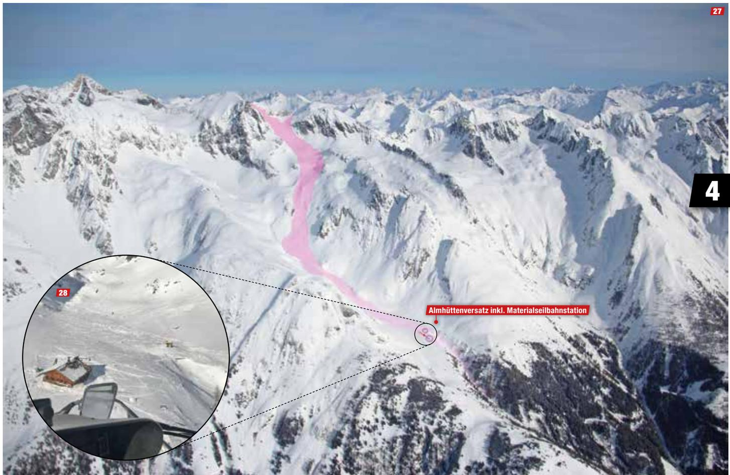
**27** Lawinabgang Nilltal 14.01./15.01.2019. Die Lawine zerstörte eine Materialseilbahnstation sowie versetzte und beschädigte die Schmiedleralm. (Foto: LWD Tirol, 19.01.2019) | **28** Die von der Staublawine verschobene Almhütte im Nilltal bei Virgen in Osttirol. Im Hintergrund die Reste der Aufzugsstation der Bonn-Matreier-Hütte. (Foto: Alpinpolizei, 16.01.2019) |
