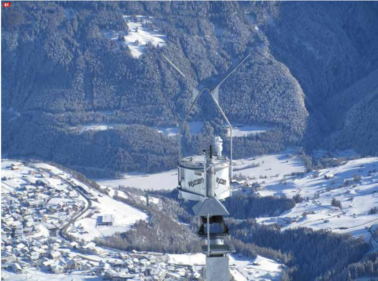
61 Sprengmast mit automatischer Kompakt-Wetterstation im Skigebiet Fiss. (Foto: WYSSSEN) |
