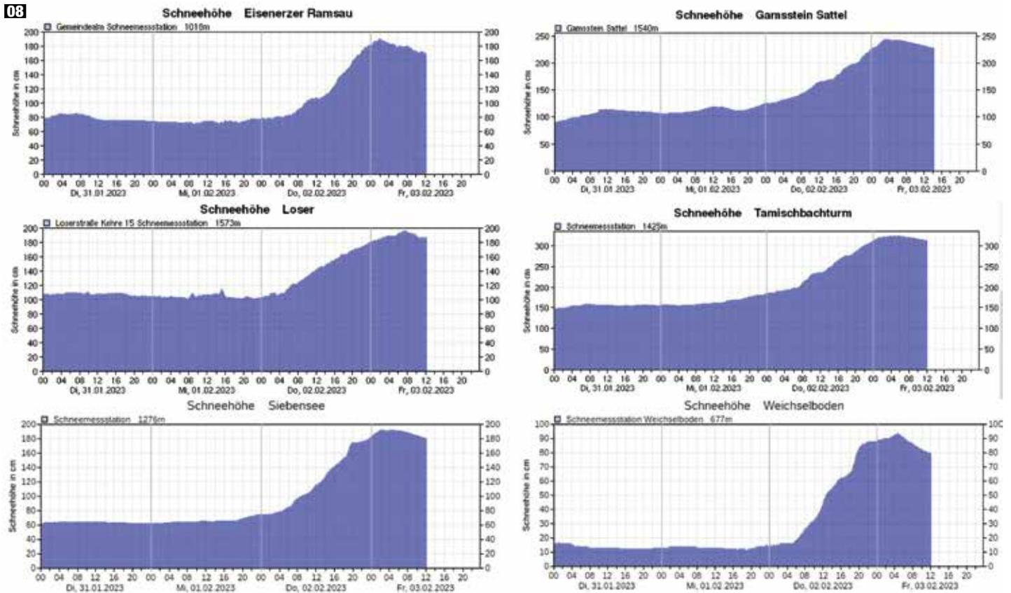
**08** Auswahl an Schneepegeln, die anschaulich den rasanten Neuschneezuwachs am 02.02.2023 zeigen. Auch gut zu erkennen: Die rasche Setzung der Schneedecke beim Nachlassen der Niederschläge durch wirksame Erwärmung sowie Schneeregen bzw. Regen. (Quelle: LWD Steiermark) |
